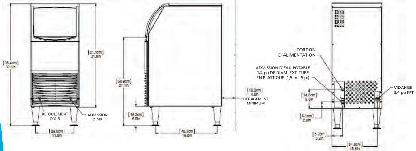
CU0415 - Machine à glaçons autonome - 41 kg (90 lb)
